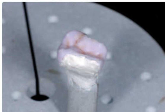
Uzupełnienie należy umieścić na płytce IPS e.max CAD Crystallization Tray w piecu, a następnie wypalić zgodnie z podanymi parametrami
