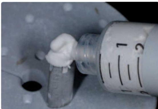
Nałożenie IPS Object Fix Flow na sztyfty IPS e.max CAD Crystallization Pin.
