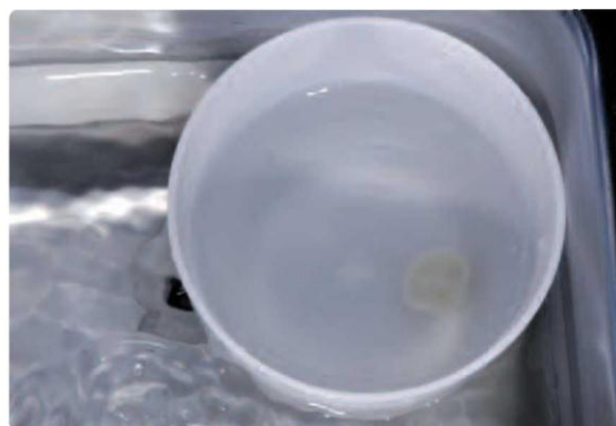
Usunąć resztki materiału przytrzymującego przy pomocy ultradźwięków w kąpeli
