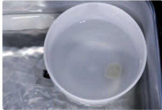
Usunąć przy pomocy ultradźwięków resztki materiału przytrzymującego
